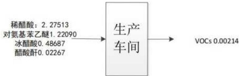
图 4.3-3 审核重点 VOCs 平衡图 (t/d)
